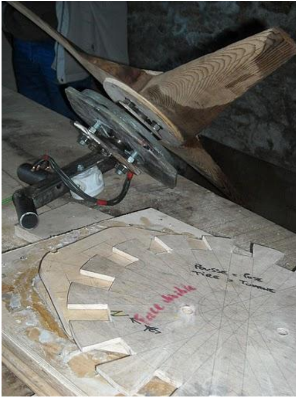
Gabarit de positionnement des aimants permanents du rotor
