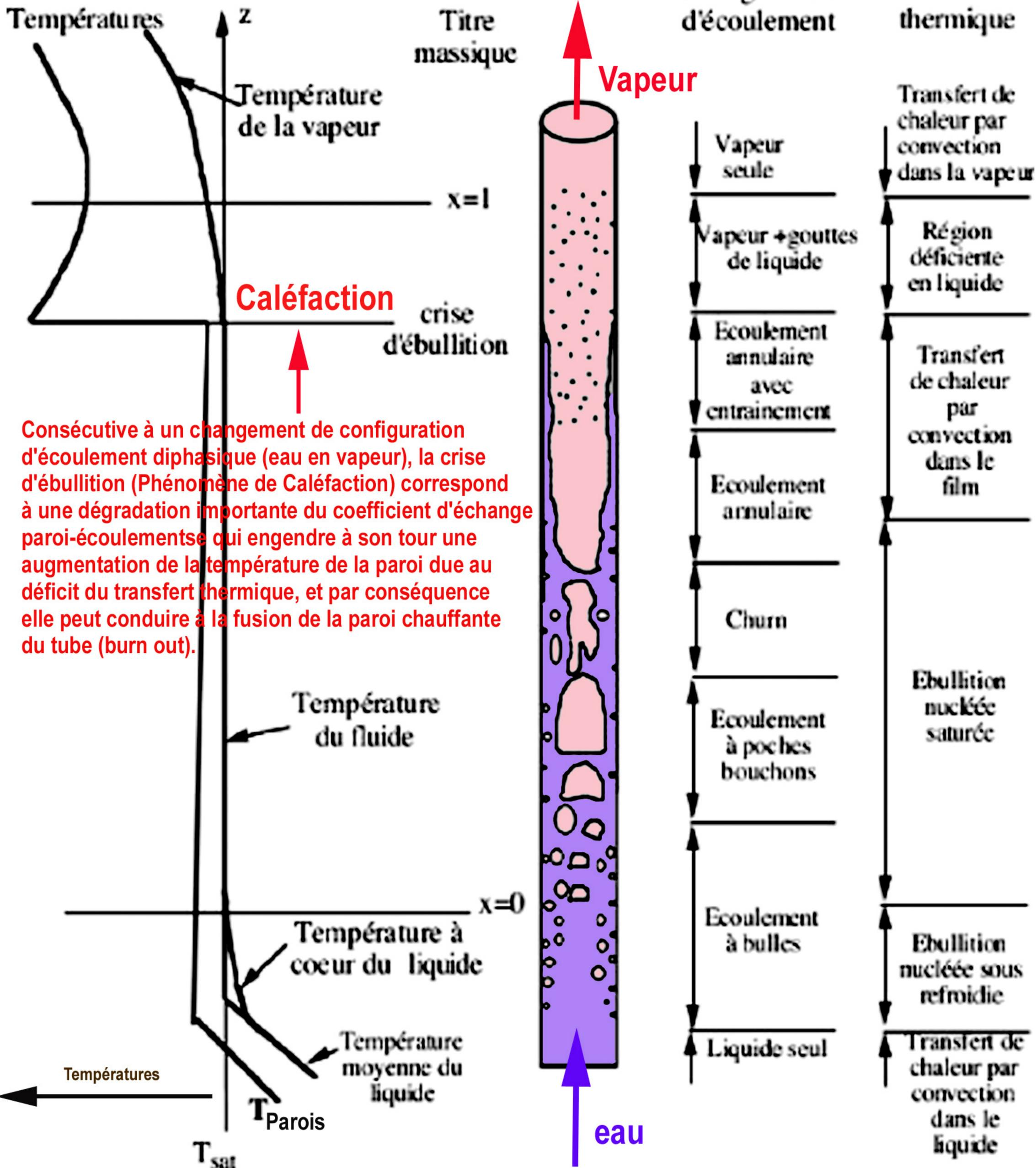
Consécutives à un changement de configuration d'écoulement diphasique (eau en vapeur), la crise d'ébullition (Phénomène de Caléfaction) correspond à une dégradation importante du coefficient d'échange paroi-écoulement qui engendre à son tour une augmentation de la température de la paroi due au déficit du transfert thermique, et par conséquent elle peut conduire à la fusion de la paroi chauffante du tube (burn out).
